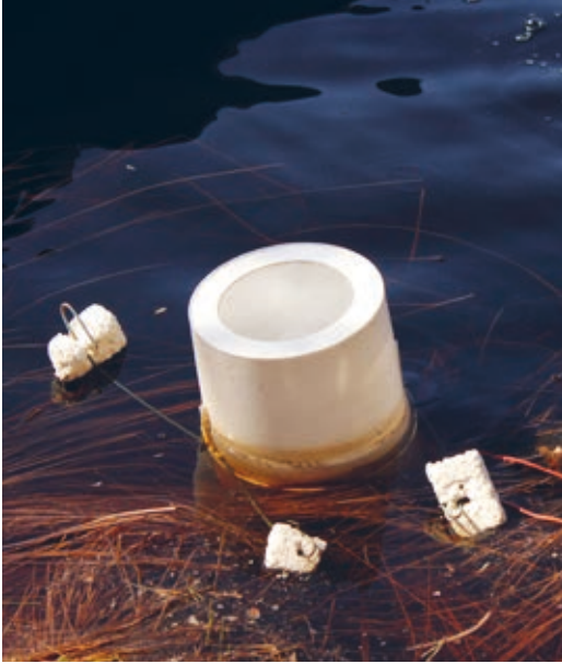
Kuorituvaissyödyksillä pyydyttiin vedestä kuorituvia hyönteisiä. Hyönteiset jäävät sankoon ansaan pyrkiessään ylöspäin.
